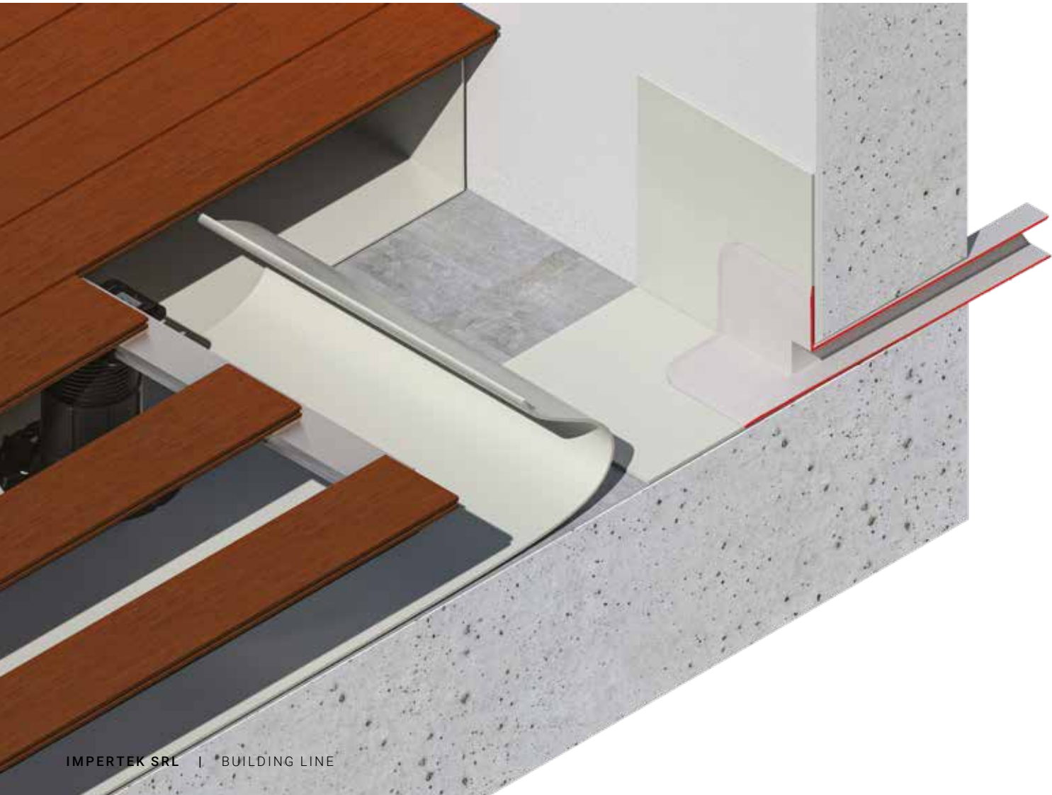
EJEMPLO DE COLOCACIÓN DE CAZOLETAS MIGNON REGULAR DE PVC CON LÁMINAS SINTÉTICAS EXEMPLOS DE COLOCAÇÃO BOCAIS MIGNON REGULAR EM PVC COM TELAS SINTÉTICAS
