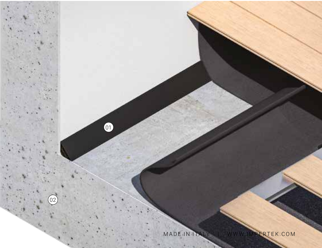
EJEMPLO DE COLOCACIÓN DE CHAFLÁN RETICULADO CON MEMBRANAS BITUMINOSAS EXEMPLOS DE COLOCAÇÃO CHANFRO RETICULADO COM MEMBRANAS BITUMINOSAS
